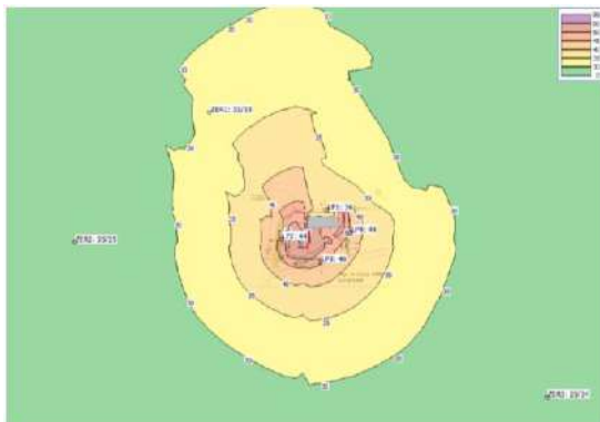
Figure 8 : Résultats de simulations des niveaux sonores dans l'environnement pour la période d'urne, en dB(A).
